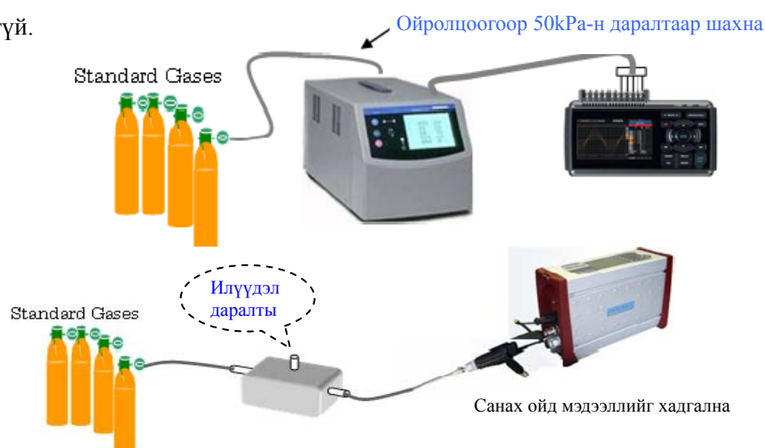
Зураг 10-1 Японд үйлдвэрлэсэн газ анализаторт стандарт хий шахах
