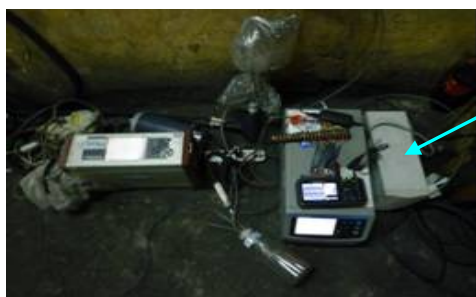
Зураг 8-16 Хийн найрлага хэмжигч газ анализаторын холболт (Дулаан өрөөнд)
